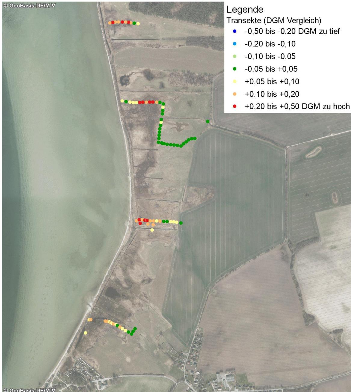
Abbildung 7: Polder Pepelow: Höhenvergleich von Digitalem Geländemodell DGM1-Daten und terrestrischen Vermessungspunkten (Berechnung DGM1-Höhe minus Vermessungshöhe)
